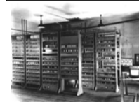
EDSAC@1939 [3000本, 12kW, 20m 2 ] (真空管でプログラム内蔵方式)
