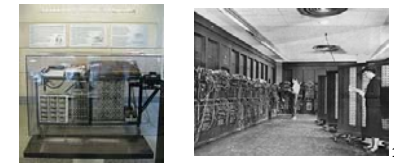
ABC@1939 (真空管でALU単機能) ENIAC@1946 [1800本, 150KW, 30t] (真空管式 プログラム可)
